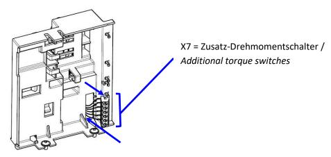
1 = Zusatz-Drehmoschalter ZU (Abtrieb rechtsdrehend) / Additional Torque switch CLOSE (output turns cw)
