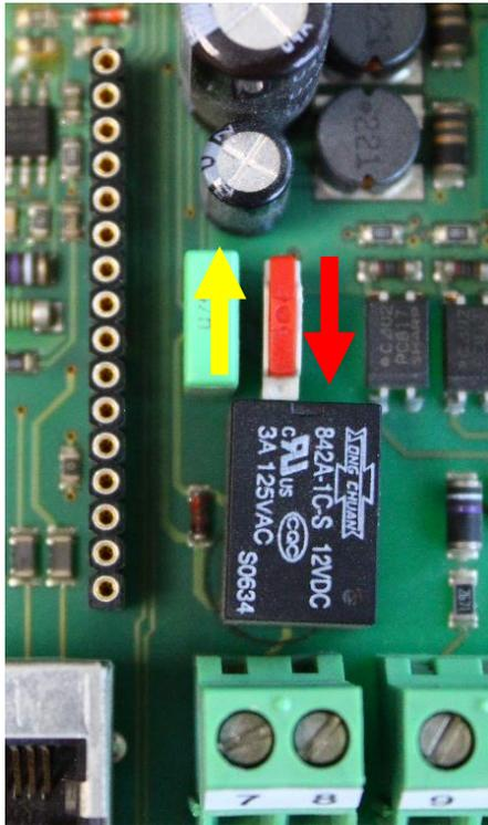
Auf der Leiterplatte im Antriebsinnenraum befindet sich ein Schiebeschalter zur Auswahl der Schnittstelle, siehe Bild 3.
