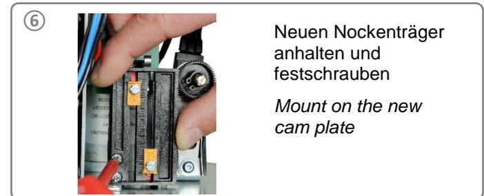
Potentiometer muss wieder neu eingestellt werden. Kupplung ganz ausfahren. Abstand vom Nockenträger zur Lagerplatte 2-3 mm (PSL201-214) bzw. 10 mm (PSL320-330). / Potentiometer must be readjusted. The drive coupling must still be in the downward position. Distance between cam plate and bearing plate 2-3 mm (PSL201-214) or 10 mm (PSL320-330).
