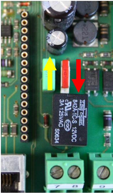
Abbildung 3 Schiebeschalter zur Schnittstellenwahl
