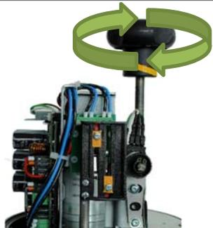
Accione el actuador con la manivela y compruebe las posiciones de las levas de conmutación
