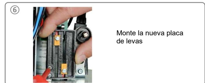
Es necesario volver a ajustar el potenciómetro. El acoplamiento debe seguir en posición hacia abajo. Distancia entre la placa de leva y la placa de soporte 2-3 mm (PSL201-214) o 10 mm (PSL320-330).
