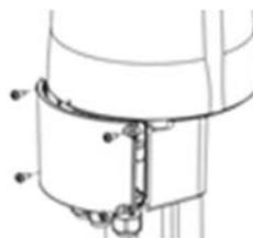
Retire la cubierta de los terminales de conexión.
