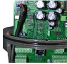
Coloque el cable en el lado izquierdo; conecte el conector azul a la toma.
