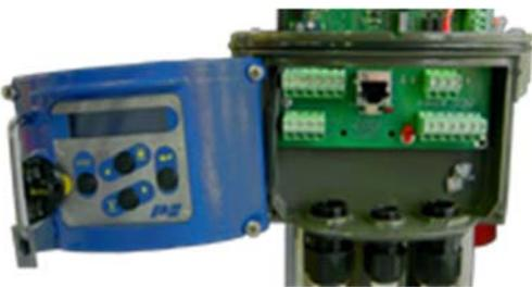
Abra la cubierta del PSC.2 para la conexión con el actuador o cableado PS-AMS. Instale siempre la cubierta abierta con el tornillo superior derecho en el orificio roscado superior izquierdo. ¡No deje que quede colgando del cable! Tras finalizar la conexión o el cableado, cierre la cubierta correctamente para un funcionamiento adecuado.
