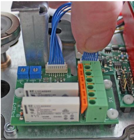
Fije la placa de relés con los espaciadores en los orificios correspondientes. Conecte la placa principal con el cable de conexión. Haga la conexión de acuerdo con el diagrama de cableado.
