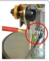
Potentiometer ausrichten und mit Mutter fixieren / Align the potentiometer and fix with a not
