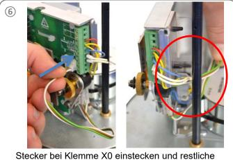
Stecker bei Klemme X0 einstecken und restliche Leitung hinter dem Zentralträger verlegen / Plug in connector at terminal XO; arrange remaining cable behind mainframe
