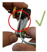
Feder auf den Sechskant aufschieben und am Metallwinkel des Potentiometers einhängen / Slip spring over the hexagon and connect it to the metal bracket of the potentiometer
