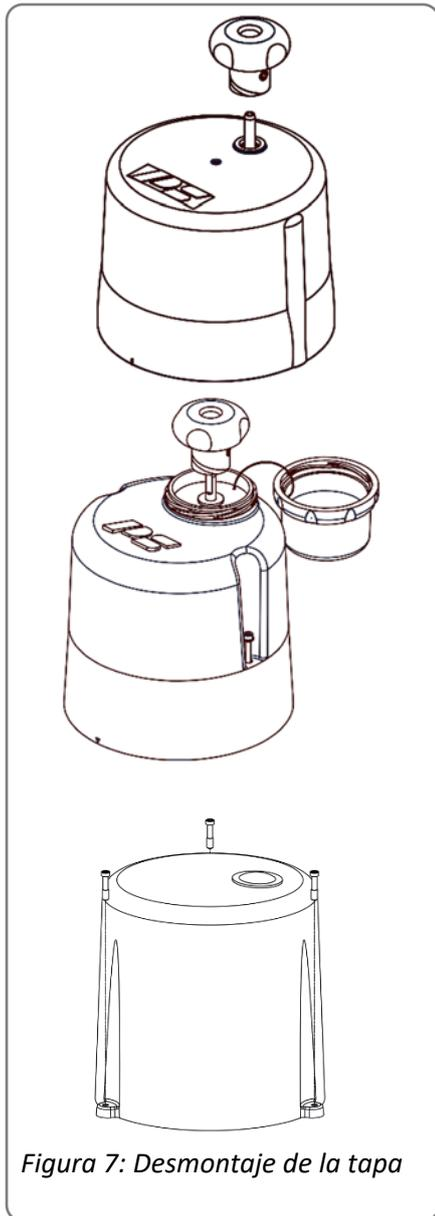
Figura 7: Desmontaje de la tapa
