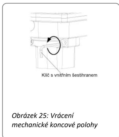
V provozu nesmí pohon PSQ-AMS trvale vypínat najetím proti internímu dorazu pohonu. Pokud byl při „vypnutí pomocí dráhy automaticky“ vytvořen doraz pro chod uvedení do provozu zašroubováním dorazového šroubu pohonu, je třeba tento dorazový šroub po dokončení uvedení do provozu bezpodmínečně znovu povolit o jedno celé otočení.
