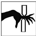
**Mechanické nebezpečí způsobené elektricky poháněnými díly pohonu!**
