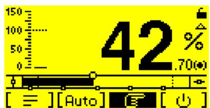
Wird der Drehschalter gedrückt und dabei gedreht wird die Feinverstellung aktiv.
