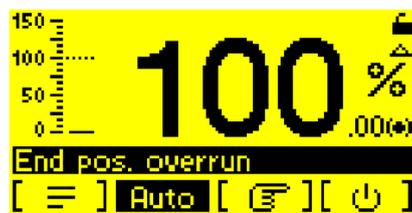
Anzeige einer Störung im Automatik Betrieb
