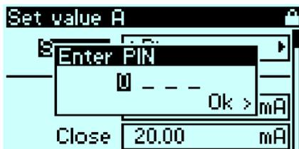
Um einen Wert in den Parametern zu ändern wird ein vierstelliger Pin benötigt. Dieser kann in der PSCS3 geändert oder deaktiviert werden.
