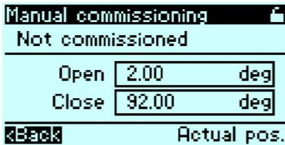
**Open:** Auswahl der Position, durch drehen kann der Wert verändert werden. Durch Drücken des Drehschalter wird der Wert übernommen.
