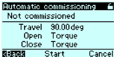
Um die automatische Inbetriebnahme zu starten „Start“ auswählen und bestätigen. Im Anschluss startet die Inbetriebnahme.
