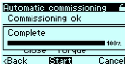
Wird die automatische Inbetriebnahme nicht erfolgreich beendet oder mit „Cancel“ abgebrochen, wird dies mit der Meldung angezeigt.
