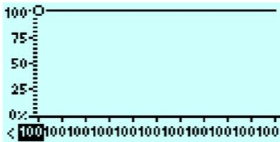
Die Stützstellen können mittels Drehschalter gewählt werden. Durch Drücken des Drehschalters und anschließendem Drehen kann der Wert verändert werden. Erneutes Drücken speichert die Einstellung dauerhaft ab.
