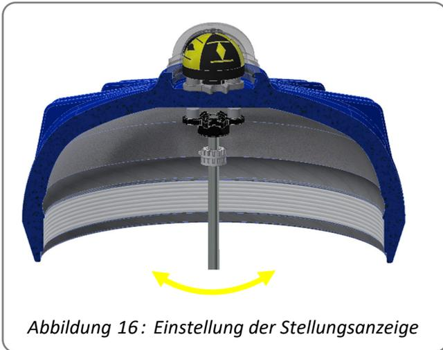
Unter der Kuppel auf der Haube des Antriebs befindet sich eine berührungslose mechanische Stellungsanzeige. Die Position der Stellungsanzeige kann auf das Ventil angepasst werden, indem der magnetische Mitnehmer unter der Haube an die entsprechende Position gedreht wird.
