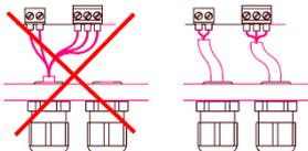
**Alle Netzanschluss- und Steuerleitungen müssen mechanisch durch geeignete Maßnahmen vor den Anschlussklemmen gegen unabsichtliches Lösen gesichert werden.**
