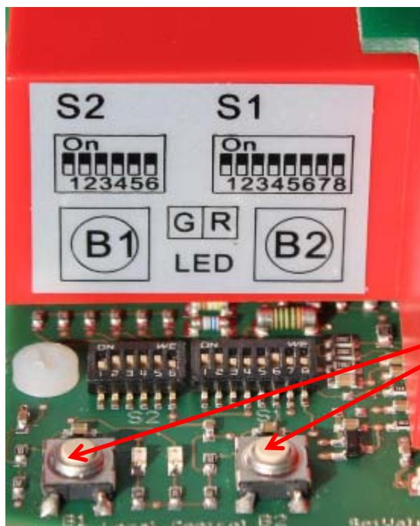
Due pulsanti sono presenti per azionare l'attuatore in caso di lavori di installazione come il montaggio su una valvola o l'impostazione delle posizioni dei finecorsa (vedere 10.6).
