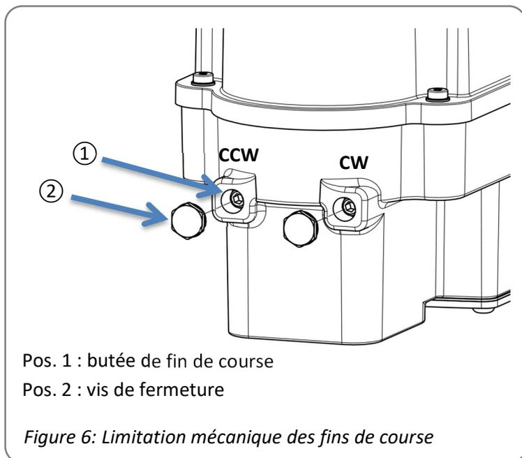
Deux butées mécaniques de fin de course réglables permettent de limiter l'angle de rotation du servomoteur.
