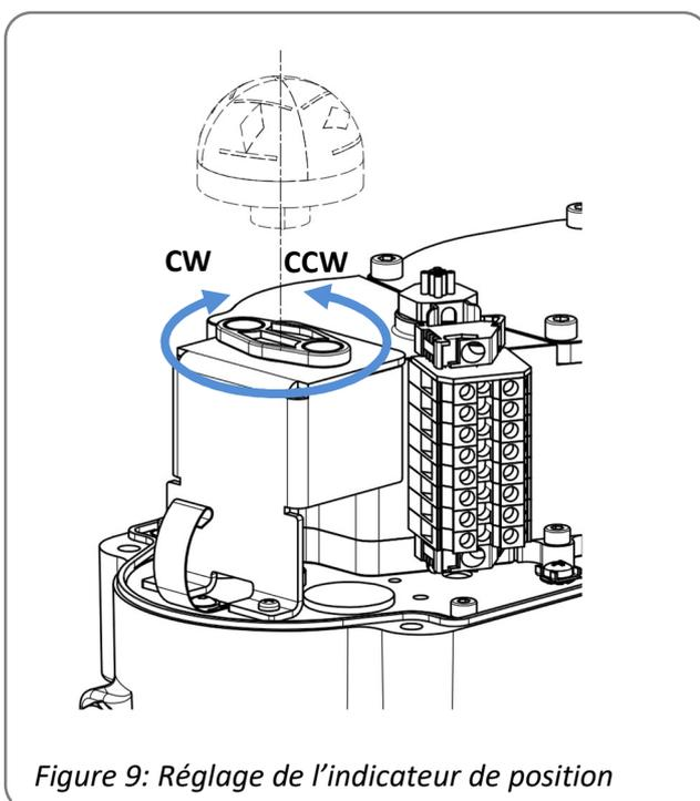
Figure 9: Réglage de l'indicateur de position
