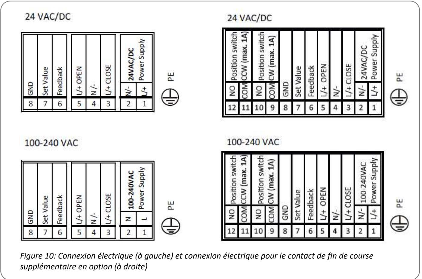
Figure 10: Connexion électrique (à gauche) et connexion électrique pour le contact de fin de course supplémentaire en option (à droite)
