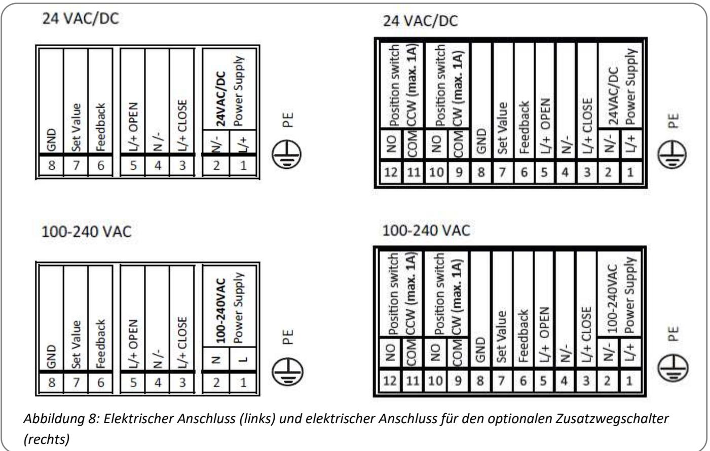
Abbildung 8: Elektrischer Anschluss (links) und elektrischer Anschluss für den optionalen Zusatzwegschiefer (rechts)
