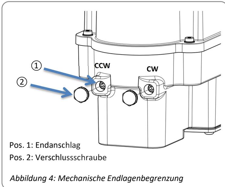
Zur Begrenzung des Antriebsschwenkwinkels stehen zwei einstellbare mechanische Endanschläge zur Verfügung. Hierzu zunächst die Verschlusschrauben lösen und die darunter liegenden Endanschläge verstellen. Danach die Verschlusschrauben wieder montieren, Anzugsdrehmoment 2 Nm.
