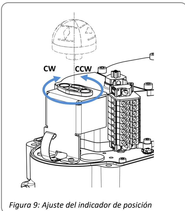
Figura 9: Ajuste del indicador de posición
