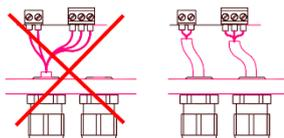
**Proteja mecánicamente todos los cables de alimentación y de control delante de los terminales adoptando las medidas adecuadas para evitar que se suelten accidentalmente.**
