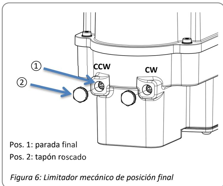
Dos toques mecánicos ajustables limitan el ángulo de giro del actuador. Para ello, afloje primero los tornillos de bloqueo y ajuste los toques situados debajo. A continuación, vuelva a colocar los tornillos de bloqueo con un par de apriete de 2 Nm.
