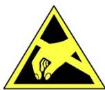
**Attenzione!** Rispettare le precauzioni relative alla manipolazione. Collegare l'attuatore a terra. Prima di aprire il coperchio, toccare le parti dell'alloggiamento collegate a terra.
