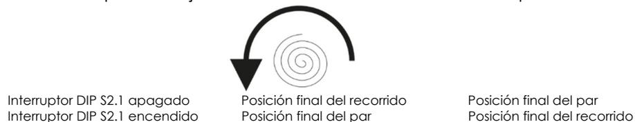
Hacia la derecha (CW) = El resorte impulsa el eje de la válvula de salida hacia la derecha
