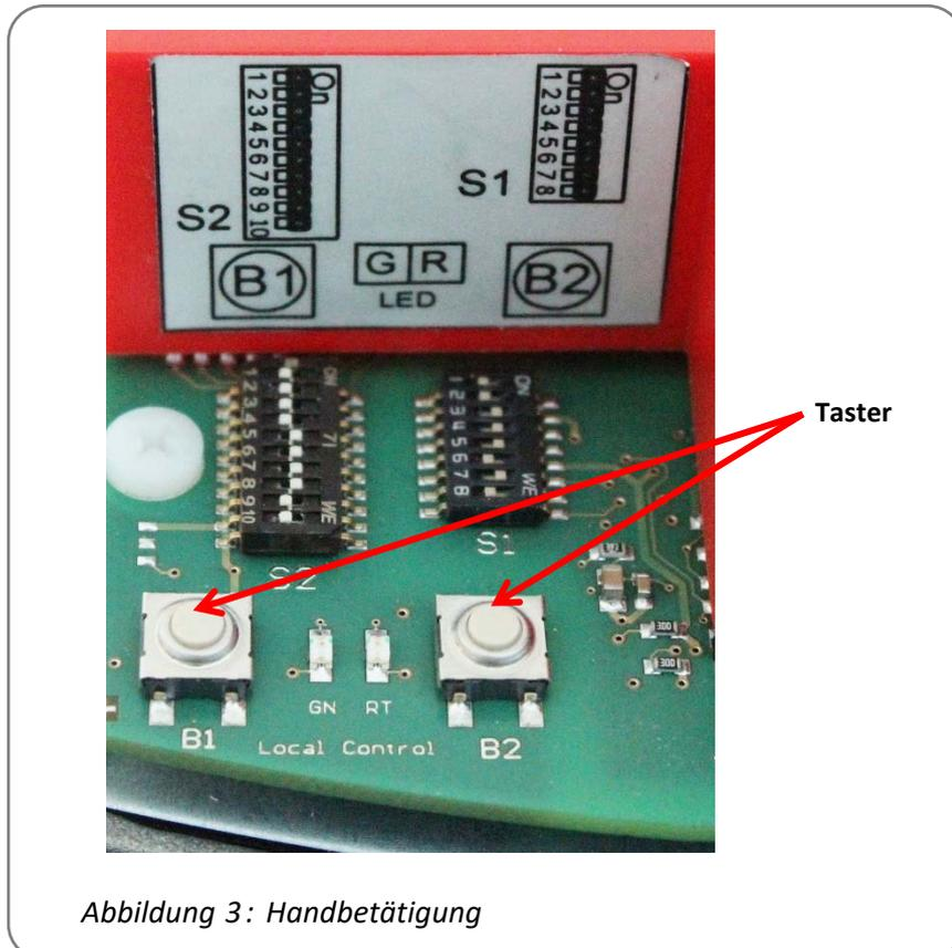
Zur Betätigung des Antriebes bei Einstellarbeiten (Ventilaufbau und Endlageneinstellung) ist eine elektrische Handbetätigung mittels Taster vorhanden (siehe 11.7).
