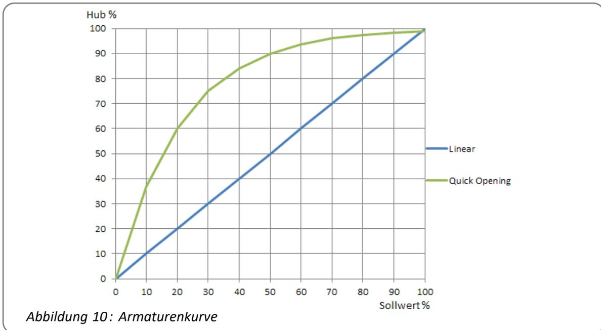
Abbildung 10: Armaturenkurve
