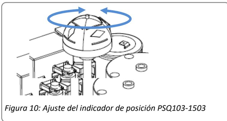
Figura 10: Ajuste del indicador de posición PSQ103-1503
