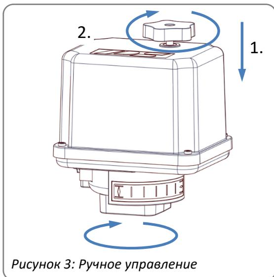
Запрещается выходить за установленные пределы электрического хода с использованием маховика.
