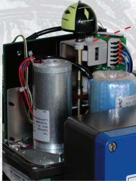
**Verbesserte Stabilität durch Metallzentralträger** für Platine und Zubehör
