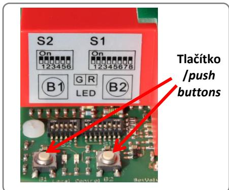
K ovládání pohonu při nastavovacích pracích (instalace ventilu a nastavení koncových poloh) je k dispozici elektrické ruční ovládání tlačítkem. (viz 10).
