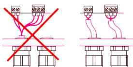
Všechna síťová připojovací a řídicí vedení musí být mechanicky vhodnými opatřeními před připojovacími svorkami zabezpečena proti neúmyslnému uvolnění.
