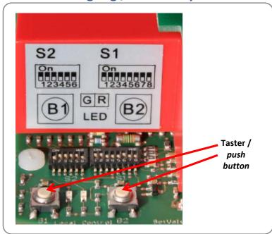
Zur Betätigung des Antriebes bei Einstellarbeiten (Ventilaufbau und Endlageneinstellung) ist eine elektrische Handbetätigung mittels Taster vorhanden. (siehe 10.).
