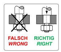
Vor dem Anziehen der Befestigungsmuttern müssen die Säulen auf der Ventiltraverse aufsitzen. Gegebenenfalls ist die Stellung des Antriebes über die Handbetätigung zu korrigieren. Bei Nichtbeachtung: Beschädigung des Antriebs!
